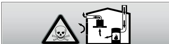
I focolari che dipendono dall'aria ambiente (per es. a gas, olio, legna o carbone, scaldabagni, caldaie elettriche) riscaldano l'aria per la combustione presente nella stanza ed eliminano i gas di scarico all'esterno attraverso un impianto (per es. camino).
