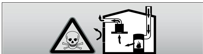
I focolari che dipendono dall'aria ambiente (per es. a gas, olio, legna o carbone, scaldabagni, caldaie elettriche) riscaldano l'aria per la combustione presente nella stanza ed eliminano i gas di scarico all'esterno attraverso un impianto (per es. camino).
