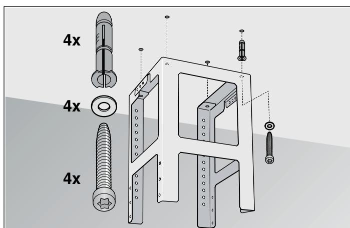
4. Trapanare quattro fori con Ø 8 mm e profondità 80 mm per il fissaggio ed inserire i tasselli a paro con il muro.
