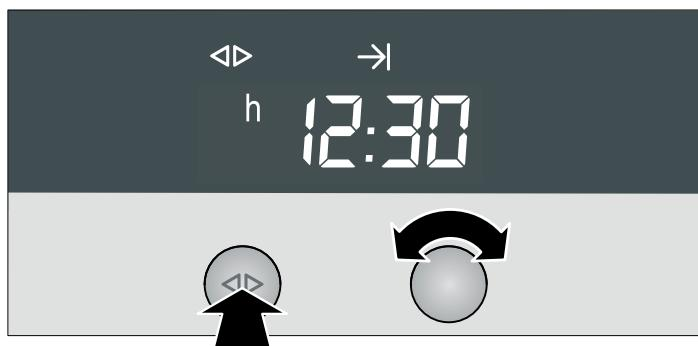
El aparato se apaga automáticamente a la hora programada para el fin de funcionamiento.
