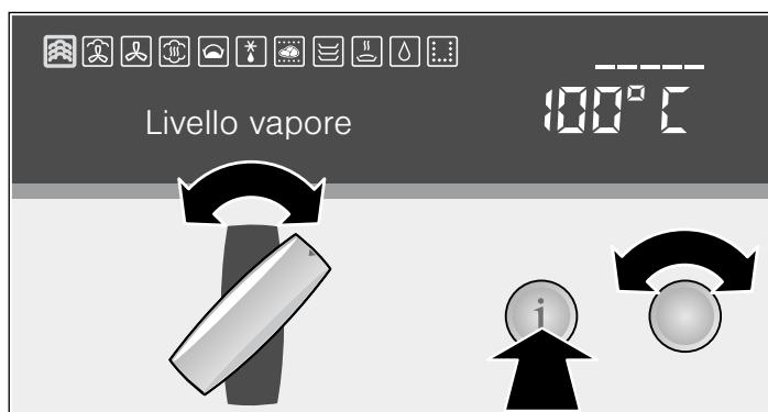
3. Ruotare il selettore della temperatura per modificare il valore predefinito.
