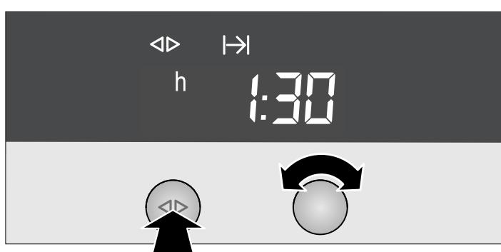
Al termine della durata di funzionamento l'apparecchio si spegne automaticamente.
