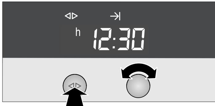
Al momento impostato per la fine del funzionamento l'apparecchio si spegne automaticamente.
