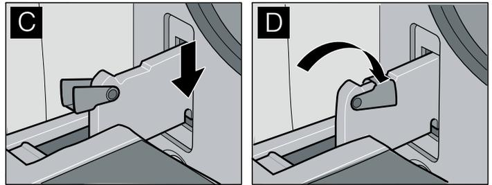
Die Gerätetür ist gesichert und kann nicht mehr ausgehängt werden.
