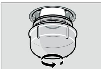
3. Backofenlampe durch den gleichen Lampentyp ersetzen.
