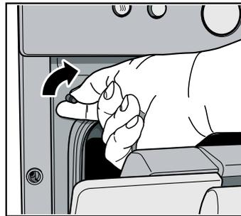
Drehen Sie den Türkontaktschalter nach rechts. Das NeffLight® ist ausgeschaltet.
