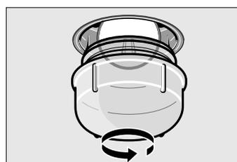
3. Backofenlampe durch den gleichen Lampentyp ersetzen.
