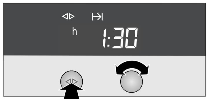
Nach Ablauf der Betriebsdauer schaltet das Gerät automatisch aus.
