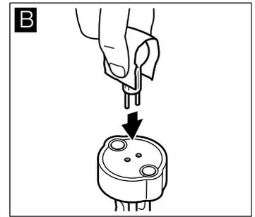
6. Lampenfassung wieder in die Gerätetür einsetzen.
