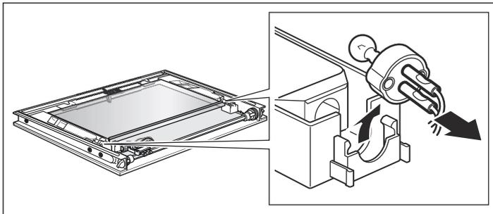
4. Defekte Halogenlampe aus der Lampenfassung herausziehen (Bild A).
