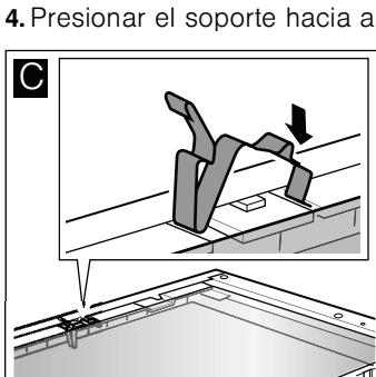
4. Presionar el soporte hacia abajo hasta que encaje (figura D).
