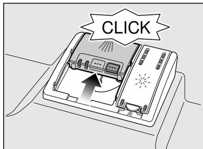
Il contenitore detersivo si apre automaticamente in funzione del programma, al momento opportuno. Il detersivo in polvere o liquido si distribuisce nell'apparecchio e si diluisce, la compressa cade nella vaschetta di raccolta compressa e qui si scioglie in modo dosato.
