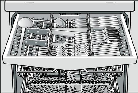
Je nach Modell können die seitlichen Ablagen heruntergeklappt werden, um mehr Platz für höhere Besteckteile zu erhalten. Die vorderen Stachelreihen können umgeklappt werden, um breitere Griffe einzusortieren.
