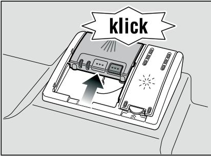
Die Reinigerkammer öffnet sich programmabhängig automatisch zum optimalen Zeitpunkt. Der Pulver- oder Flüssigreiner verteilt sich im Gerät und wird aufgelöst, der Tab fällt in die Tab-Auffangschale und löst sich dort dosiert auf.
