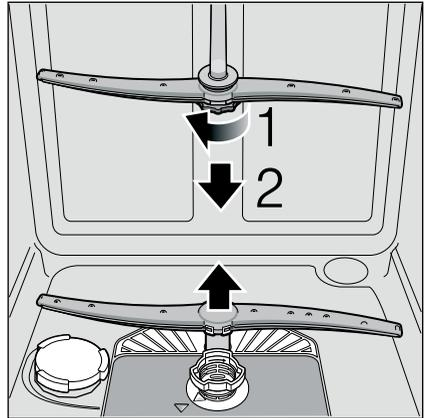
4. Sprüharme unter fließendem Wasser reinigen.
