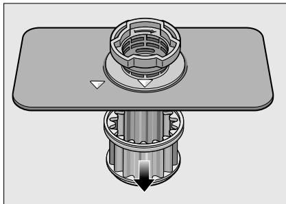
3. Eventuelle Reste entfernen und Siebe unter fließendem Wasser reinigen.
