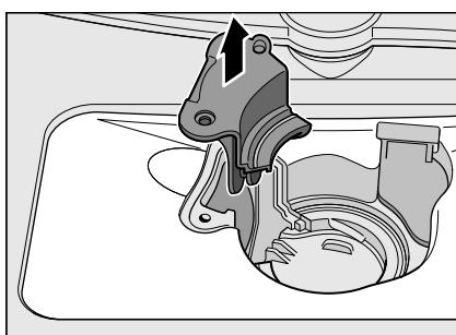
5. Innenraum kontrollieren und gegebenenfalls Fremdkörper entfernen.
