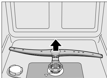
3. Sprüharm unter fließendem Wasser reinigen.
