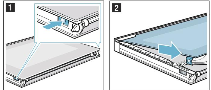
5. Zwischenscheibe im Bereich a nach unten drücken, Halterung b vorsichtig anheben, bis sie sich herausziehen lässt (Bild 3).
