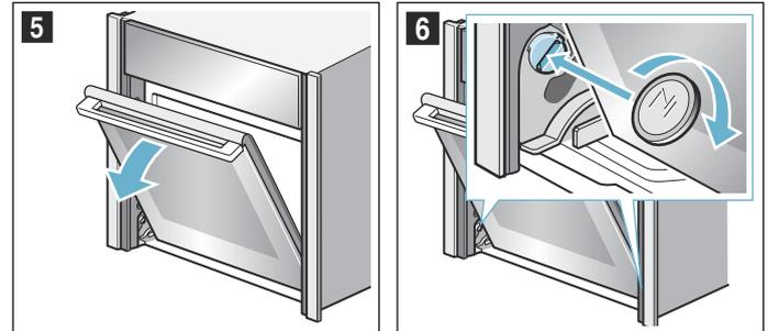
4. Gerätetür etwas schließen, bis die Arretierungen spürbar einrasten. Die Tür darf sich nicht mehr schließen lassen.
