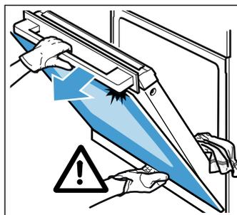
**Remarque :** Si la vitre frontale ne se détache pas, saisir le bord supérieur de la vitre d'une main et tirer dans le sens de la flèche jusqu'à ce qu'elle se détache.
