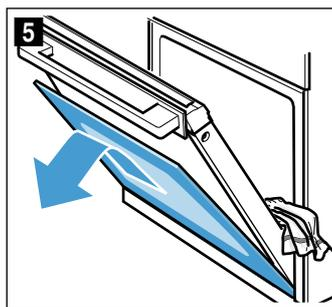
5. Déposer la vitre frontale sur une surface moelleuse plane.
