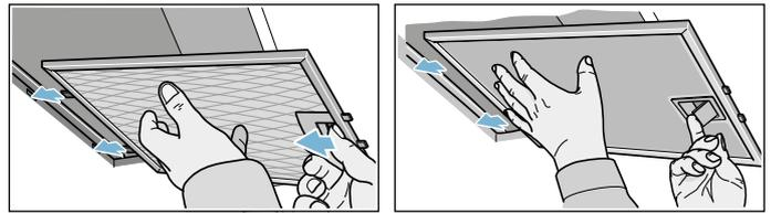
Bei Randabsaugungsfiltren, den Metallfettfilter nach unten ziehen. Dabei mit der anderen Hand unter den Metallfettfilter fassen.
