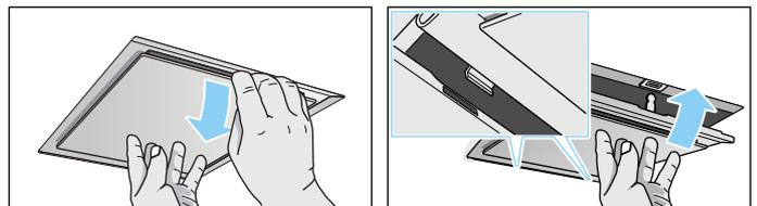
Bei Zusatzfiltren im Innenraum, Verriegelung öffnen und den Metallfettfilter herunterklappen. Dabei mit der anderen Hand unter den Metallfettfilter fassen.
