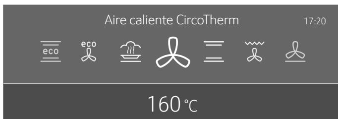
2. Deslizar el dedo hacia la izquierda o la derecha para seleccionar el tipo de calentamiento.
