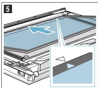
5. Presionar el cristal intermedio en la zona **b** hacia abajo, insertar el soporte **c** en posición inclinada y presionar hasta que encaje (figura 6).
