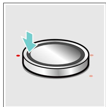
Den Twist-Knopf so auf das Twistpad setzen, dass er sich in der Mitte der Anzeigen befindet, die den Twistpad-Bereich eingrenzen.
