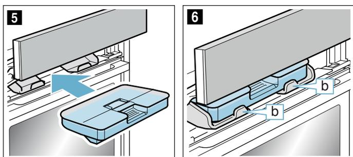
9. Spingere lentamente verso il basso il pannello, poi premerlo all'indietro finché non è completamente chiuso. Il serbatoio dell'acqua è riempito. Ora è possibile avviare il funzionamento con il vapore.
