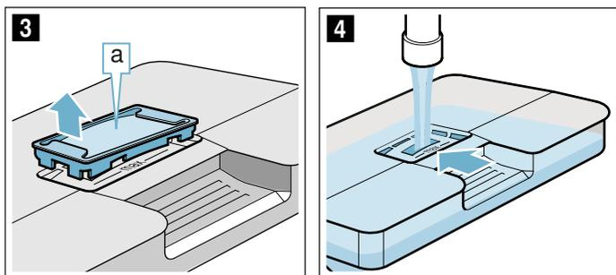
7. Inserire nuovamente la copertura **a** nell'apertura del serbatoio dell'acqua.
