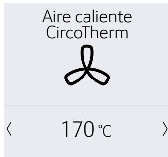
**Nota:** Se pueden realizar otros ajustes según el modo de funcionamiento. Para realizar cualquier otro ajuste, desplazarse a las siguientes líneas con la tecla ↘. Seleccionar el ajuste con la tecla < o >.
