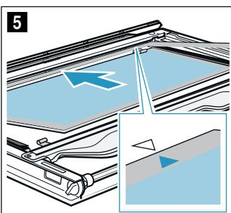
5. Presionar el cristal intermedio en la zona **b** hacia abajo, insertar el soporte **c** en posición inclinada y presionar hasta que encaje (figura 6). El soporte está colocado (figura 7).
