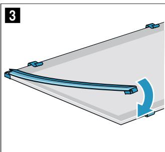
3. Colocar el cristal intermedio con las juntas y los distanciadores. La flecha sobre el cristal intermedio debe coincidir con la flecha sobre el marco (figura 4).
