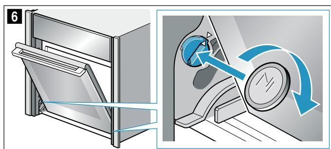
Bloqueo de la parte izquierda fijado (figura 7)
