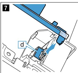
7. Zweiten Reflektor rechts wie den linken Reflektor einsetzen.
