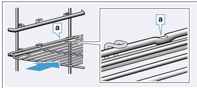
Achten Sie beim Einschieben von Blechen darauf, dass die Rastnase **b** hinten ist und nach unten zeigt. Die Abschrägung des Zubehörs **c** muss vorne zur Gerätetur zeigen.
