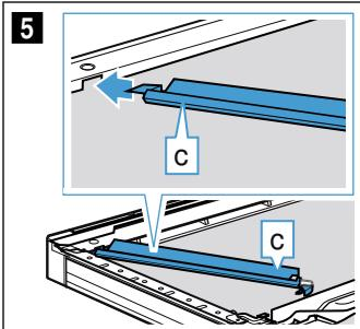
5. Reflektor **c** einsetzen (Bild 6).
