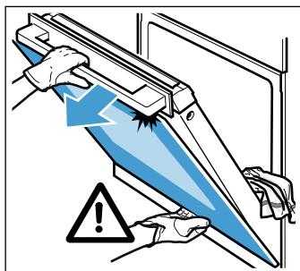
**Hinweis:** Wenn sich die Frontscheibe nicht löst, greifen Sie oben mit einer Hand die Kante der Frontscheibe und ziehen Sie in Pfeilrichtung, bis sie sich löst.
