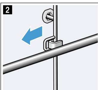
Reinigen Sie die Gestelle mit Spülmittel und einem Spülenschwamm. Bei hartnäckigen Verschmutzungen verwenden Sie eine Bürste.
