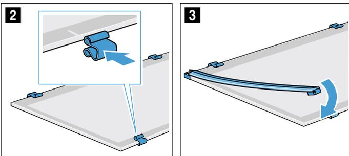
3. Inserire il pannello intermedio con le guarnizioni e i distanziatori. La freccia sul pannello intermedio deve coincidere con la freccia sul telaio (figura 4).
