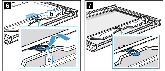
6. Inserire il pannello interno obliquamente verso la parte posteriore nella barra di tenuta **d** (figura 8).
