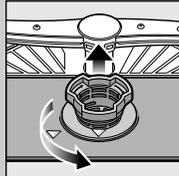
Zeefcylinder eruit draaien, zeefstelsysteem eruit halen ...
