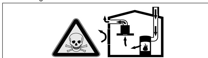
Vuurbronnen die de lucht in de ruimte verbruiken (bijv. apparaten die op gas, olie, hout of kolen worden gestookt, geisers, warmwateroestellen) trekken de verbrandingslucht uit de opstellingsruimte en voeren de gassen via een afvoer (bijv. schoorsteen) af naar buiten.
