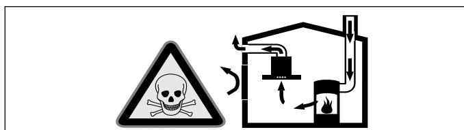
I focolai che dipendono dall'aria ambiente (per es. a gas, olio, legna o carbone, scaldabagno, caldaie elettriche) ricavano l'aria per la combustione dalla stanza ed eliminano i gas di scarico all'esterno attraverso un impianto (per es. camino).
