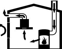
Les foyers à combustion alimentés en air ambiant (par exemple appareils de chauffage, au gaz, au bois, au fioul ou au charbon, les chauffe-eau, chauffe-eau accumulateurs) prélèvent l'air de combustion dans la pièce où ils sont installés et rejettent les gaz de fumée à l'extérieur par le biais d'un système spécifique (cheminée par exemple).
