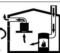
Raumluftabhängige Feuerstätten (z.B. gas-, öl-, holz- oder kohlebetriebene Heizgeräte, Durchlauferhitzer, Warmwasserbereiter) beziehen Verbrennungsluft aus dem Aufstellraum und führen die Abgase durch eine Abgasanlage (z.B. Kamin) ins Freie.
