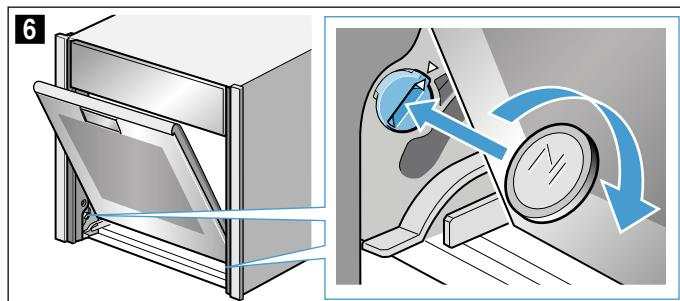
Фиксатор с левой стороны зафиксирован (рис. 7)
