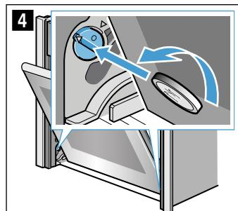
Левый фиксатор: против часовой стрелки
