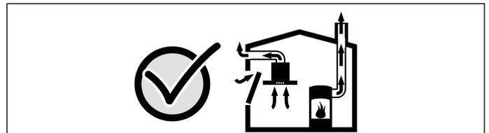
Ζητήστε σε κάθε περίπτωση τη συμβουλή του αρμόδιου καπνοδοχοκαθαριστή, ο οποίος μπορεί να εκτιμήσει το συνολικό σύστημα αερισμού του σπιτιού και να σας προτείνει το κατάλληλο μέτρο αερισμού. Εάν ο απορροφητήρας λειτουργεί αποκλειστικά στην λειτουργία ανακυκλοφορίας αέρα, τότε η λειτουργία είναι δυνατή χωρίς περιορισμό.
