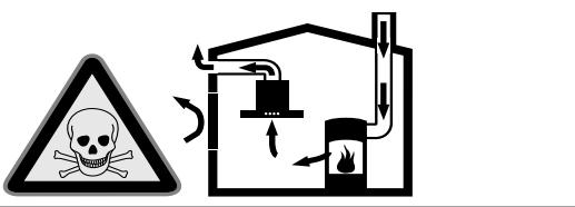
Εστίες, εξαρτημένες από τον αέρα του περιβάλλοντος (π.χ. συσκευές θέρμανσης που λειτουργούν με αέριο, πετρελαιο, ξύλο ή άνθρακα, ταχυθερμοσίφωνες, θερμαντήρες νερού) λαμβάνουν τον αέρα για καύση από το χώρο τοποθέτησης και οδηγούν τα καυσαέρια μέσα από μια εγκατάσταση απαγωγής των καυσαερίων (π.χ. καμινάδα) στον έξω χώρο.
