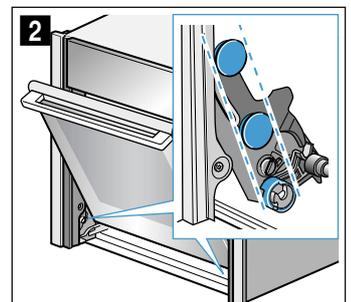
2. Achten Sie darauf, dass die Gerätetür das letzte kleine Reststück vollständig nach unten rutscht (Bild 3).
