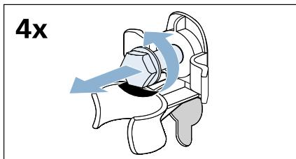
3. Retirar los manguitos. Retirar para ello el cable de conexión de las sujetaciones.
