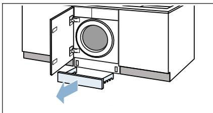
4. Extraer el tubo auxiliar de desagüe de su soporte.
