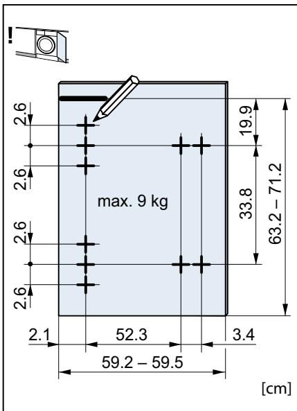
8. Perforar los agujeros. Para el orificio de  $\varnothing$  35 mm, utilizar una broca Forstner.
