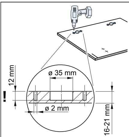
9. Introducir las bisagras en los agujeros perforados y atornillarlas. Atornillar las contraplacas del cierre magnético.
