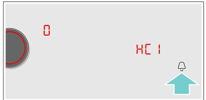
3. Mit dem Twist-Knopf Wert **1** "Automatisch verbinden" oder Wert **2** "Manuell verbinden" einstellen.
