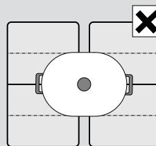
Sur les tables de cuisson possédant plus d'une zone de cuisson flexible, placez le récipient sur la table de cuisson de telle manière qu'il ne recouvre qu'une seule zone de cuisson flexible. Sinon les foyers ne seront pas correctement activés et il ne sera pas possible d'obtenir un bon résultat de cuisson.
