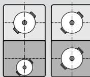
Zonele de gătit din față și din spate, fiecare cu două inductoare, pot fi utilizate independent unele de altele. Setați treapta de fierbere dorită pentru fiecare zonă de gătit individuală. Pe fiecare zonă de gătit utilizați numai un sigur vas de gătit.
