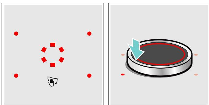
Twist-gumb stavite na Twist-podlogu tako da se nalazi u sredini indikatora koji ograničavaju područje Twist-podloge.
