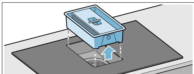
3. Pritisnite oba elementa za zatvaranje na stranama spremnika kako biste odvojili metalni filter za masnoću od spremnika.
