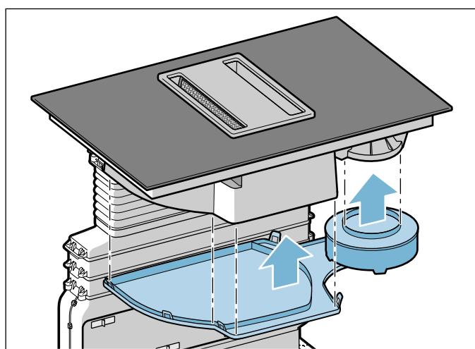
2. Ispraznite i isperite preljevni spremnik i po potrebi poklopac kućišta.
