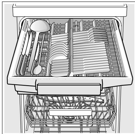
Según el modelo, los soportes laterales se pueden abatir para disponer de más espacio para colocar cubiertos de mayor tamaño en el lavavajillas. Las filas delanteras de ganchos se pueden abatir para colocar piezas de vajilla de asas anchas.
