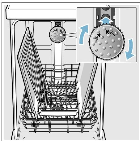
Con objeto de asegurar que el chorro de agua alcance todas las piezas cargadas en la máquina, las bandejas y rejillas deberán colocarse tal como se muestra en la ilustración (carga máxima: 2 bandejas pasteleras y 2 rejillas).
