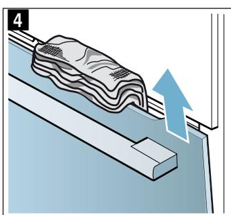
**6. En el cristal intermedio, por arriba, presionar las dos sujeciones hacia arriba pero no extraer (figura 5). Sujetar el cristal firmemente con una mano. Extraer el cristal.**
