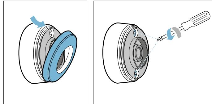
2. Aprire la copertura del sensore di temperatura. Estrarre la batteria dalla parte inferiore dell'alloggiamento e inserire una nuova batteria (prestare attenzione al corretto orientamento dei poli della batteria).
