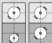
Le zone di cottura anteriore e posteriore, ciascuna con due induttori, possono essere utilizzate indipendentemente l'una dall'altra. Per ciascuna delle zone di cottura impostare il livello di cottura desiderato. Utilizzare solo un'unica stoviglia per ciascuna zona di cottura.
