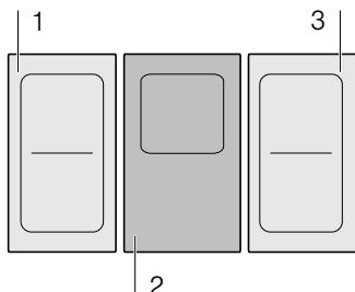
**Avvertenza:** Con l'area di cottura flessibile, la funzione Shortboost può essere anche attivata quando viene utilizzata come zona di cottura singola.
