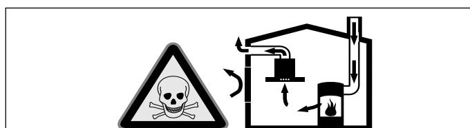
I focolari che dipendono dalla temperatura ambiente (per es. a gas, olio, legna o carbone, scaldabagno, caldaie elettriche) riscaldano l'aria per la combustione presente nella stanza ed eliminano i gas di scarico all'esterno attraverso un impianto (per es. camino).
