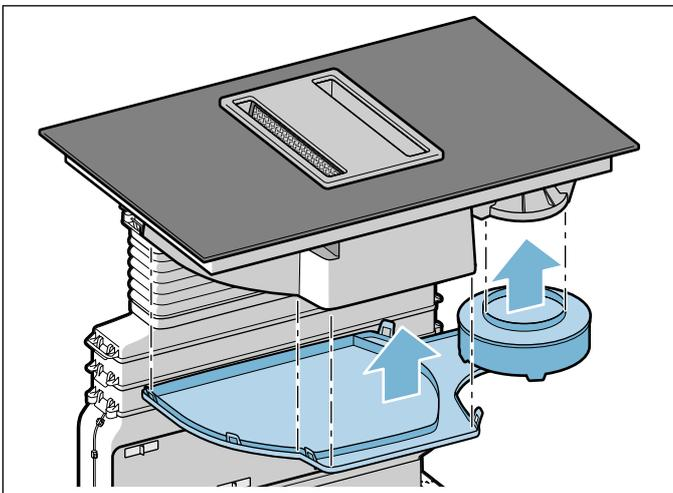
2. Überlaufbehälter und ggf. Gehäuseabdeckung ausleeren und ausspülen.
