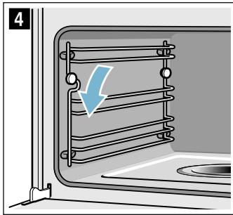
Les supports ne s'adaptent respectivement que d'un côté.
