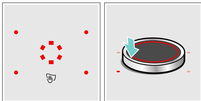
Den Twist-Knopf so auf das Twistpad setzen, dass er sich in der Mitte der Anzeigen befindet, die den Twistpad-Bereich eingrenzen.
