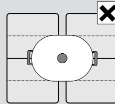
Kod ravnih ploča za kuvanje sa više od jedne fleksibilne zone za kuvanje posuđe postavite tako da pokriva samo jednu od fleksibilnih zona za kuvanje. Ringle se inače ne aktiviraju propisno i ne postiže se dobar rezultat kuvanja.
