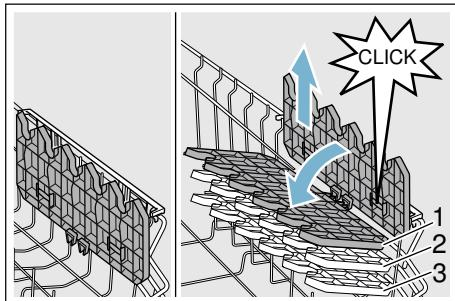
În funcție de varianta de dotare a mașinii dvs. de spălat vase puteți să reglați etajera în înălțime de 3 ori.
