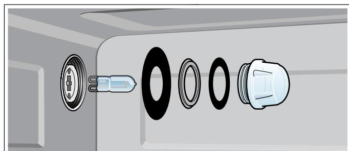
5. Înșurubați la loc capacul de sticlă cu garniturile.
