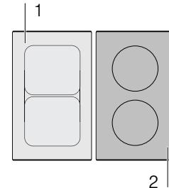
**Remarque :** Au niveau de la zone combinée, la fonction Powerboost peut uniquement être activée si les deux foyers sont utilisés indépendamment l'un de l'autre.
