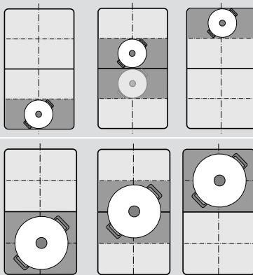
Esto permite desplazar el recipiente a otra área de cocción, con diferente nivel de potencia, durante el proceso de cocción:
