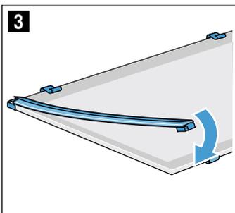
3. Zwischenscheibe mit Dichtungen und Abstandshalter einsetzen. Der Pfeil auf der Zwischenscheibe muss mit dem Pfeil auf dem Rahmen übereinstimmen (Bild **4**).
