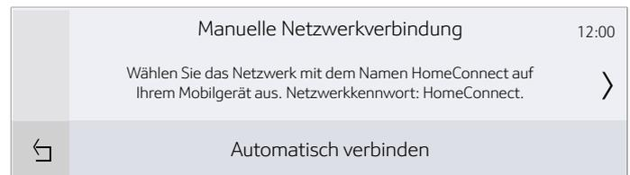
Gerät bereit zur Herstellung der manuellen Netzwerkverbindung. Im Display stehen die SSID und das Netzwerkennwort des Backofen-Netzwerks.
