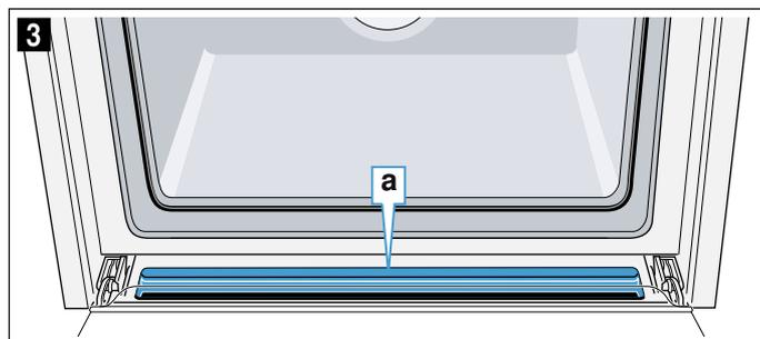
**Remarque :** Si le joint s'est détaché, remplacez le joint sur la gouttière. → "Porte de l'appareil" à la page 34
