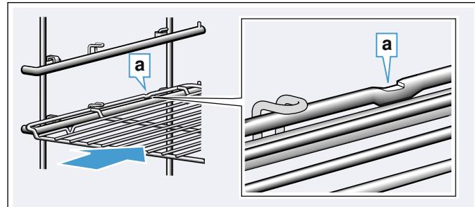
Achten Sie beim Einschieben von Blechen darauf, dass die Rastnase **b** hinten ist und nach unten zeigt. Die Abschrägung des Zubehörs **c** muss vorne zur Gerätetur zeigen.
