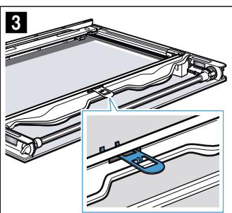
3. Innenscheibe links und rechts in die Halterung **c** einstecken (Bild **4**).
