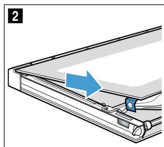
5. Zwischenscheibe im Bereich **a** nach unten drücken, Halterung **b** vorsichtig anheben, bis sie sich herausziehen lässt (Bild **3**).
