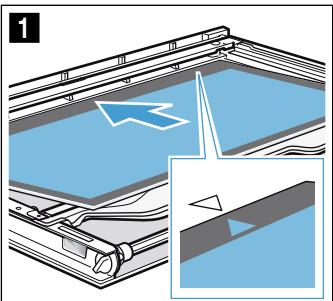
2. Zwischenscheibe im Bereich **a** nach unten drücken, Halterung **b** schräg einschieben und andrücken, bis sie einrastet (Bild **2**).
