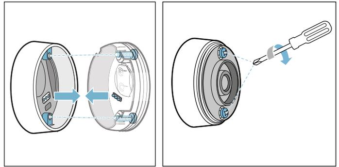
4. Colocar de nuevo el protector de silicona en la base del Sensor de cocción.
