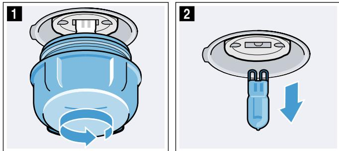
4. Glasabdeckung wieder eindrehen. Je nach Gerätetyp ist die Glasabdeckung mit einem Dichtring ausgestattet. Dichtring vor dem Eindrehen wieder aufsetzen.
