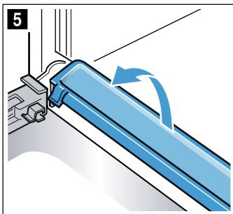
Reinigen Sie die Scheiben mit Glasreiniger und einem weichen Tuch. Wischen Sie die Kondensatleiste mit einem Tuch und heißer Spülflüssigkeit ab.
