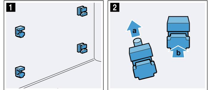
3. Die Halterung hinten mit dem Haken in das obere Loch einhängen **a** und in das untere Loch eindrücken **b** (Bild **3**).
