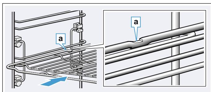
Achten Sie beim Einschieben von Blechen darauf, dass die Kerbe **a** hinten ist und nach unten zeigt. Die Abschrägung des Zubehörs **b** muss vorne zur Gerätetur zeigen.
